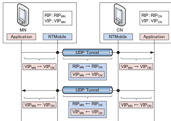
図 3 トンネル通信時の動作
