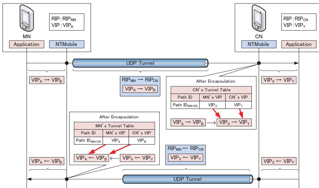
図 6 トンネル通信時のアドレス遷移
