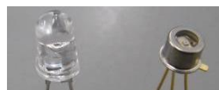
図 2 使用した受光素子 (左:赤色 LED, 右:PD (S7912))
