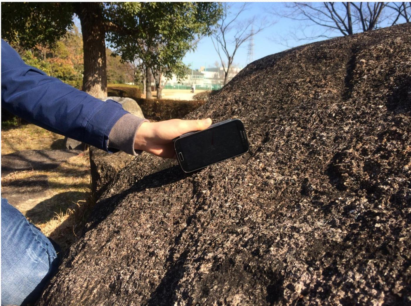
傾斜角度 (Angle of Dip) の測定方法
