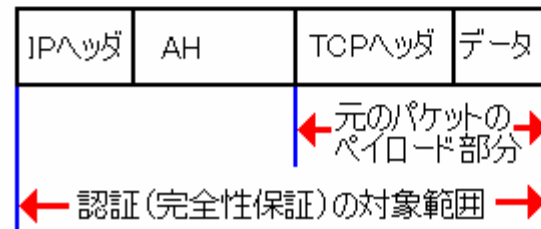
トランスポートモードでIPsec(AH)化されたパケット
